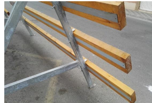
Barrera con refuerzo en 3 tablones.
